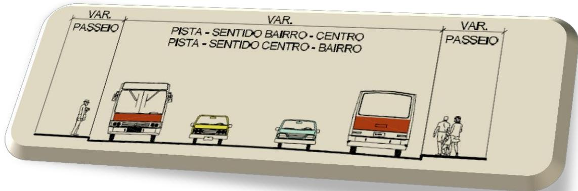
**Figura 3-2** – Seção com duas faixas por sentido sem canteiro central.
